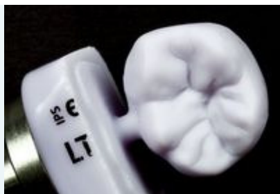
Abb. 3: „As machined“: Aus dem blauen Rohling geschliffene monolithische Krone in der aktuellen Frässtrategie von absolute Ceramics. Kontinuierliche technische Verbesserungen bei der schleifenden Bearbeitung von Dentalkeramik ermöglichen immer idealere Schleifergebnisse.
