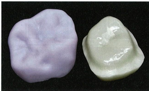
Abb. 7: Eine noch nicht kristallisierte aus IPS e.max® CAD geschliffene Verblendschale (blau) und das gesinterte dazugehörige Zirkonoxidgerüst (weiß).
