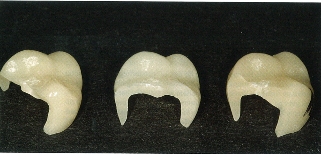
◀ Abb. 9 Frakturen der Kronenserie VI: IPS e.max CAD-Vollkeramikkronen nach der Belastungsprüfung
