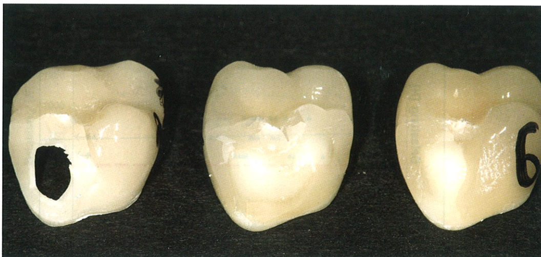
► Abb. 8 Gerüst- und Verblendungsfrakturen der Kronenserie II: Infix-Kronen nach der Belastungsprüfung
