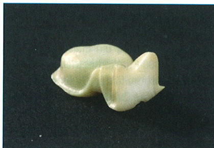
Abb. 8: Durch das tiefe Eindringen der Tauchfarblösung entstehen keine hellen Flecken an der Schleifstelle.
